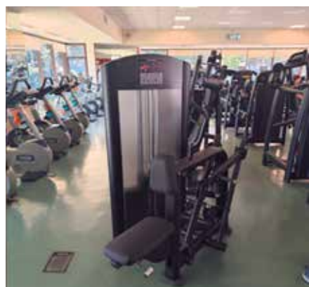
RESTAURACIÓN MÁQUINA DE REMO (arenado – pintado al horno – tapizado)
